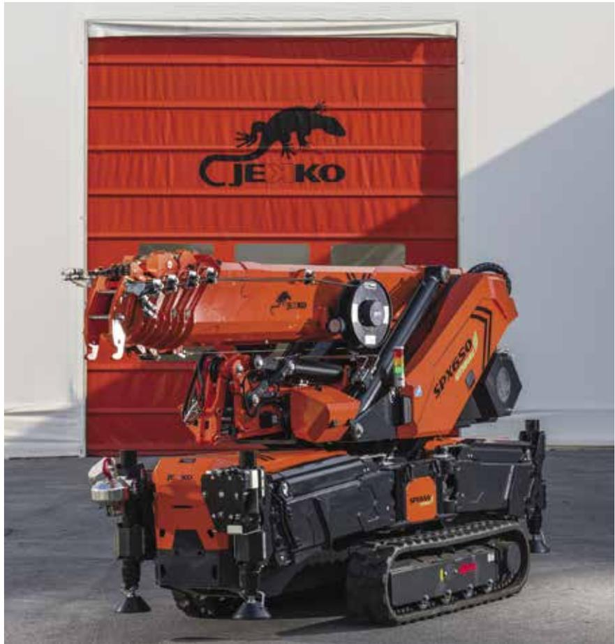
LA MINI GRU JEKCO SPX650 È DOTATA DI UN PACCO BATTERIE A LITIO DA 48V PROGETTATO SU SPECIFICHE JEKCO, CON CAPACITÀ 400 AH, CHE ALIMENTA UN MOTORE ELETTRICO TRIFASE DA 16 KW
