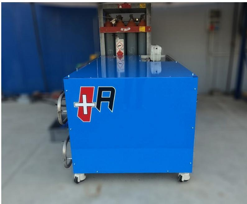
La batteria è affiancata da un sistema di produzione di energia elettrica ad idrogeno che consente di ricaricarla quando è scarica.
